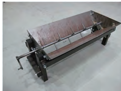
図4 穀物ブリッジ解消試験装置
