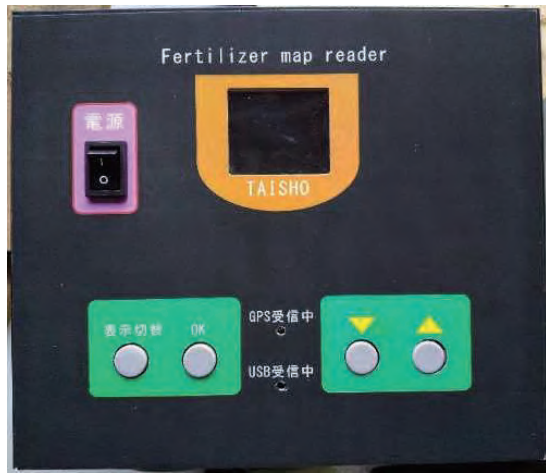
図1 開発した可変施肥システム
