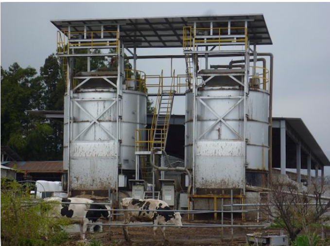
写真4-1. 密閉縦型堆肥化装置外観 実証酪農家(栃木県那須塩原市; 搾乳牛100頭規模)所有の密閉縦型堆肥化装置(中部エコテック製D63型、2基)
