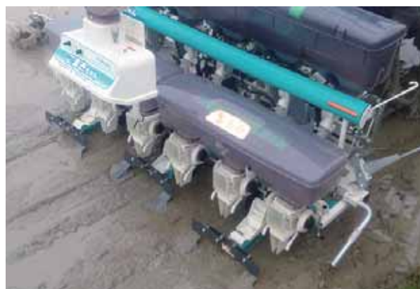
写真9 覆土アタッチメントの装着状態（写真左）と播種作業の様子（写真右）
