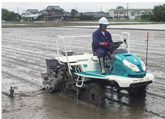
写真8 鉄コーティング直播機（写真左）と開発した覆土アタッチメント（写真右）
