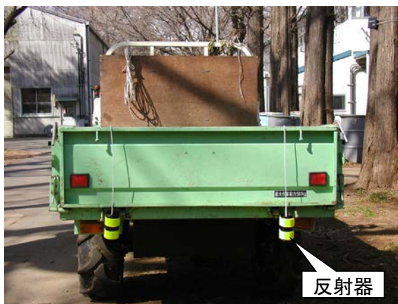
空き缶反射器を取付けた状態
