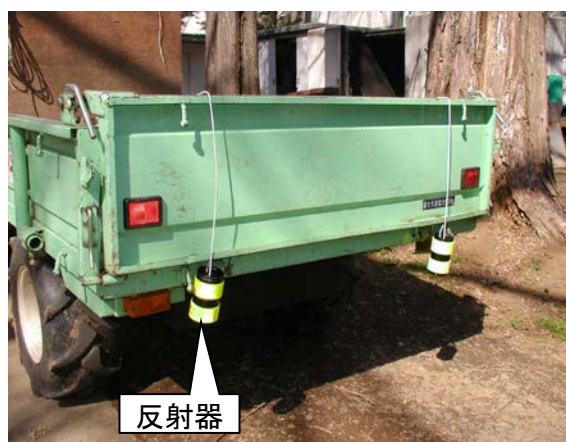
空き缶反射器を取付けた状態
