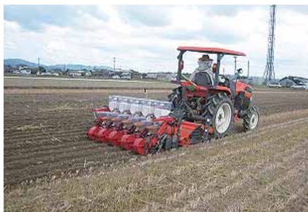
写真1 部分浅耕-工程播種 注)ロータリーは150cm、5条播
