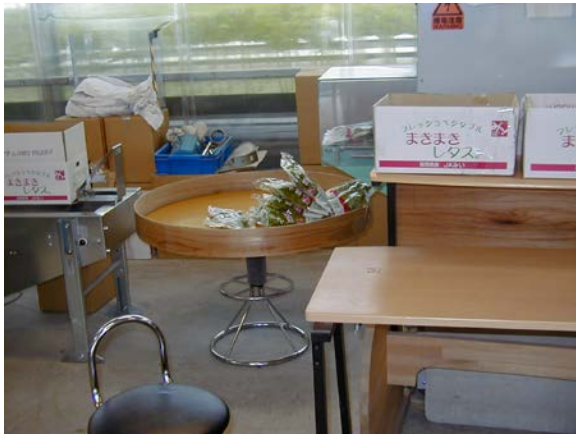
作目：野菜 作業：選別・調製 目的：効率化・省力化 方法：包装机と箱詰め台間に一時的に溜めておく回転テーブルを設置。
