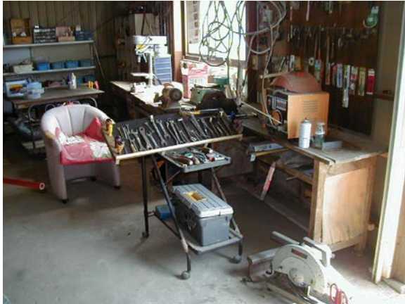
作目：共通 作業：機械使用・管理 目的：施設整備、重量物負担軽減 方法：工具をキャスタ付台車に収納、運搬。
