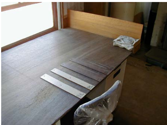
作目：花卉 作業：選別・調製 目的：効率化・省力化 方法：切り揃える長さの位置に線を引いて定規を製作した。
