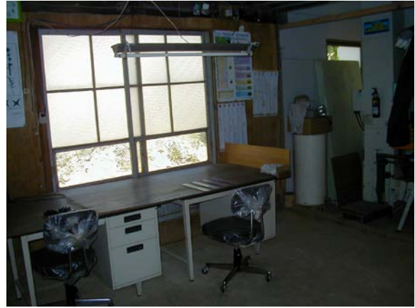
作目：花卉 作業：選別・調製 目的：明るさ調節 方法：作業台の上に照明を追加した。
