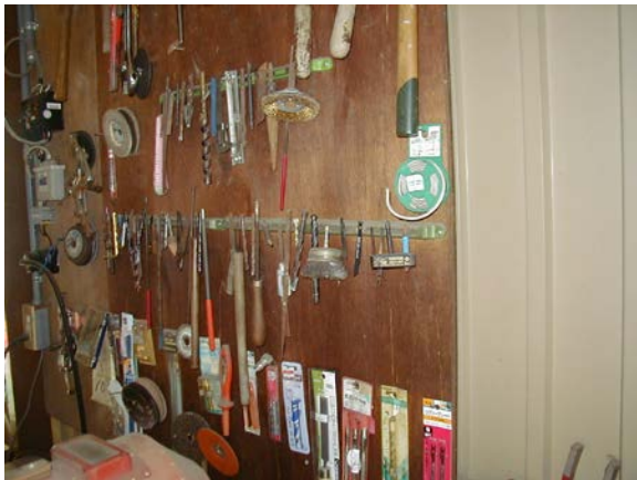
作目：共通 作業：機械使用・管理 目的：施設整備 方法：道具を磁石に貼り付けたら、フックに掛けて収納。
