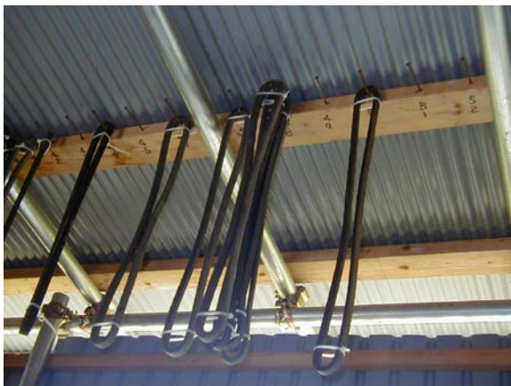
作目：共通 作業：機械使用・管理 目的：施設整備 方法：頻繁に交換するベルトサイズを記入して保管。
