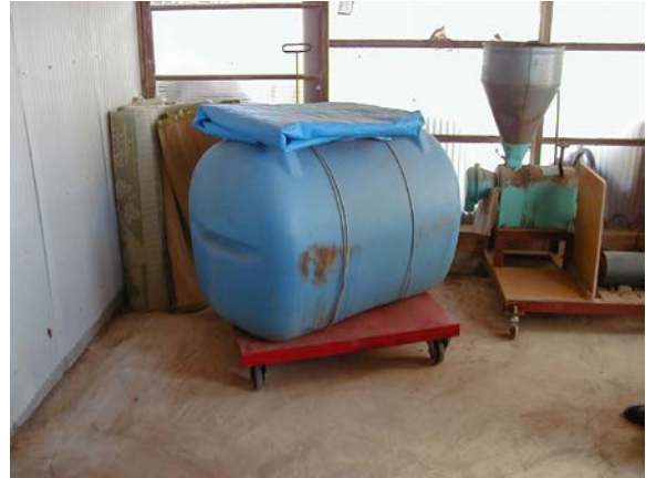
作目：共通 作業：機械使用・管理 目的：重量物負担軽減 方法：作業機をキャスタ付き台に載せて保管、運搬。
