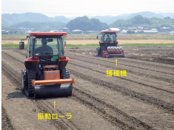
図1 振動ローラで漏水を防止する
