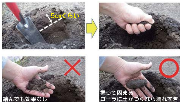
図2 漏水防止効果が高い状態かを現場で確認する
