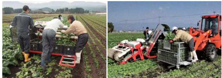
写真2 構築した機械収穫体系でのホウレンソウの収穫作業 (左: 小型コンテナ横流れ方式 右: メッシュコンテナ・ベルトコンベア方式)
