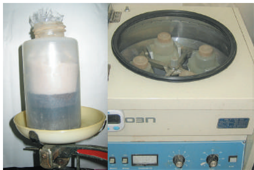
③ 予め遠沈管(250ml容) に入れた85mlの比重液（60%ショ糖水溶液）上に、②の土壌懸濁液を重層して遠心分離（2,000rpm、1分30秒間）
