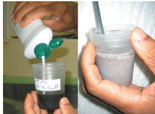
② ベルマントレイ法で線虫を分離後の土壌に25gのクリームクレンザーを混和
