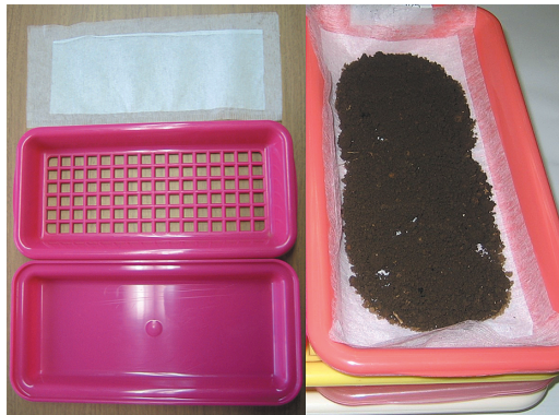
① ベルマントレイ法で50gの検査土壌から線虫群集（活動性のある個体）を分離
