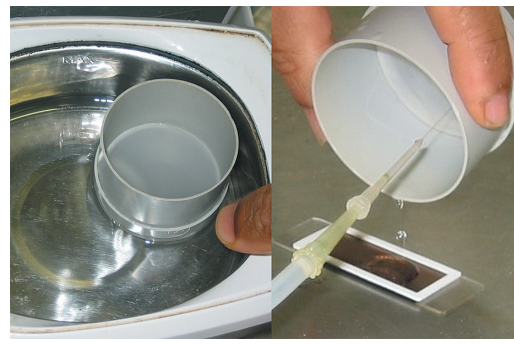
④ 遠心分離後の上澄みを超音波洗浄槽に浮かべた孔径10 \mu mの篩に通じて線虫群集（活動性のない個体も含まれる）を濃縮
