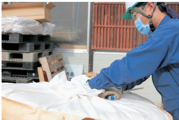
フレコン投入口の結束作業：1名
