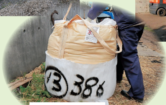
開封時のフレコン (傷などの損傷なし)
