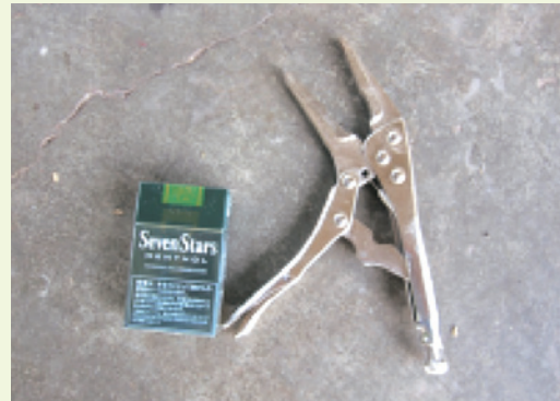
バイスクリップで ビニール帯を引っ張って締める
