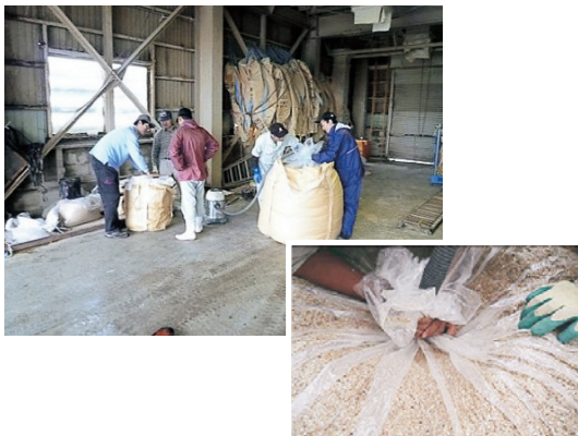
人力で行われていた脱気・密封作業
