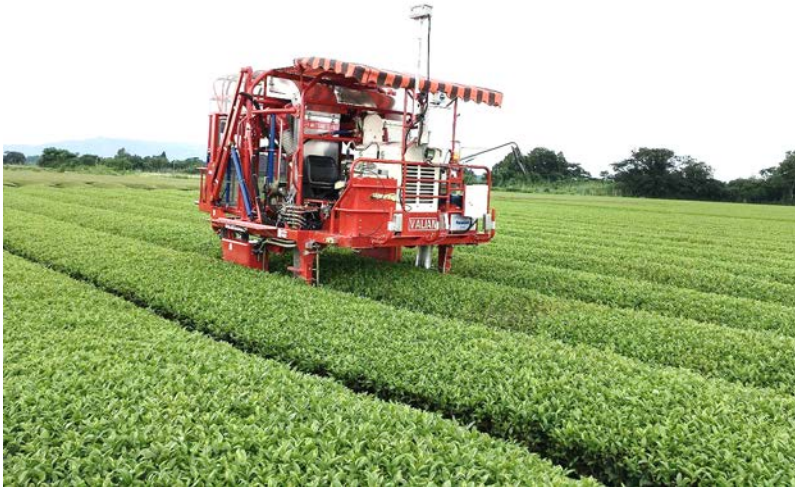
写真4. 無人で走行する摘採機の実証試験
