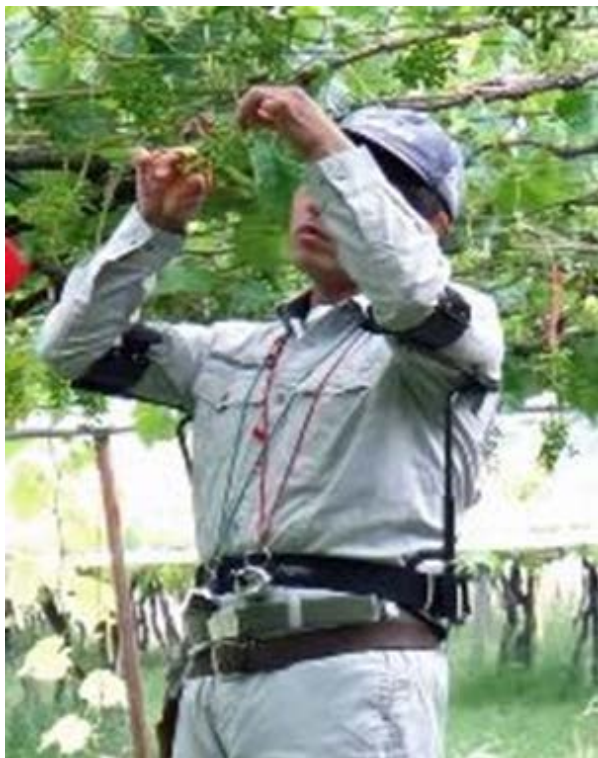
写真3 腕上げ作業補助器具（商品名「腕楽つく」：農研機構・株式会社ニッカリ共同開発）
