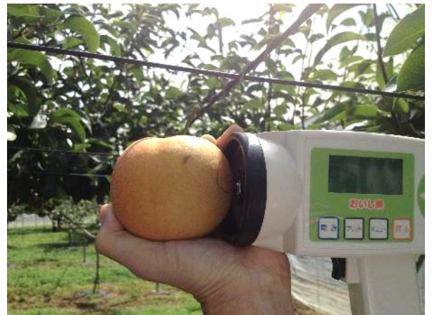
図2 非破壊計測器での計測 計測器(右の機器)から光を果実に当て、特定波長の反射光を測定しています。
