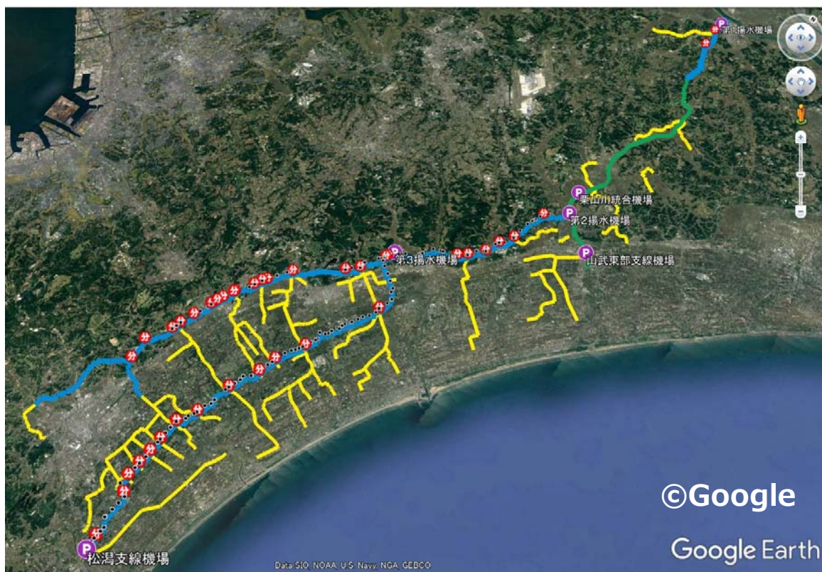
— 幹線水路 (パイプラインが主) — 栗山川疎水路 Data SIO, NOAA, U.S. Navy, NGA, GEBCO — 支線水路 (開水路が主) P ポンプ場 分 分水工 ● 空気弁、制水弁、排泥工など
