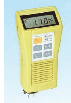
図28 試験で使用した木材水分計 (株) サンコウ電子研究所 木材水分計 AQ-10 (TG-H モードで測定)
