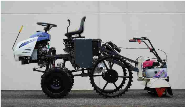
図1 中山間ビークル1号機(本機+耕うん作業機)
