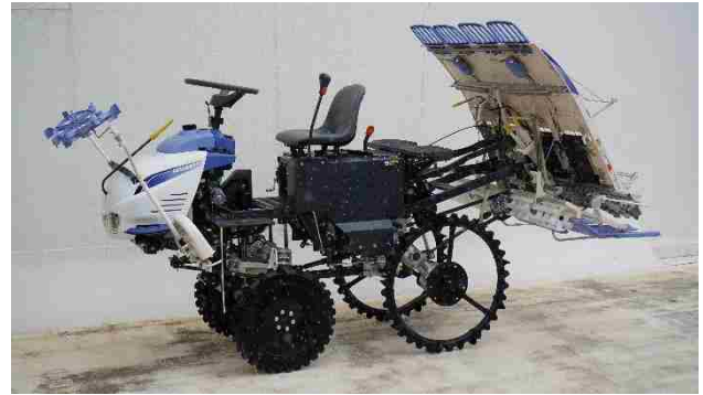
図2 中山間ビークル2号機(本機+田植作業機)
