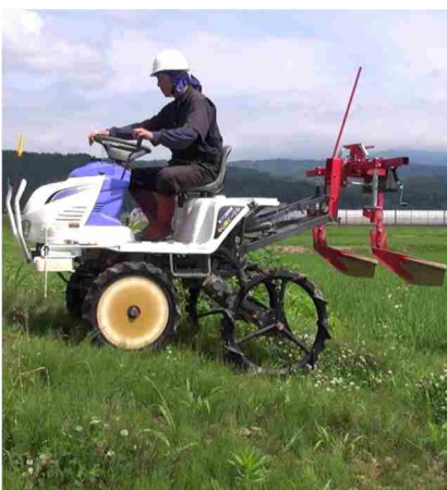
図4 車輪昇降機構を利用した 傾斜地走行の様子 (溝切作業機装着時)
