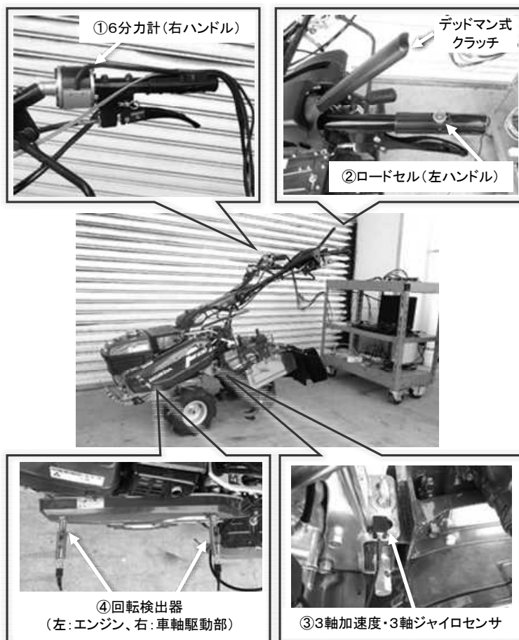
図1 測定器の構成と歩行用トラクタ
