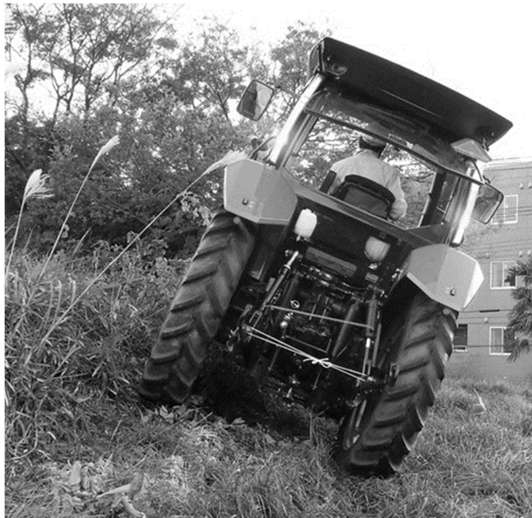
図2 法面走行による転倒時緊急通報機能の動作確認風景
