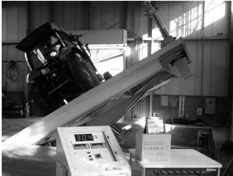
図1 傾斜試験装置での転倒時緊急通報機能の動作確認風景
