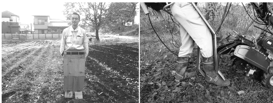
図2 危険挙動測定時の被験者下肢保護用エプロン
