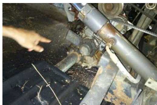
図13 故障の多い走行部
