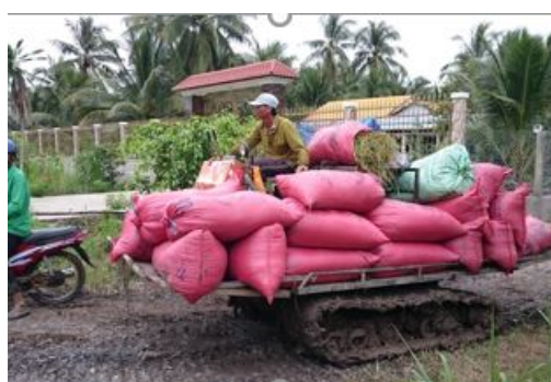
図 15 雨天直後での作業風景 (右：湿田、冠水田の中で使うクローラ式の籾運搬機)
