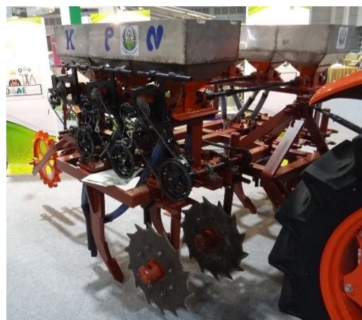
図 11 自転車の変速機を用いた 播種機
