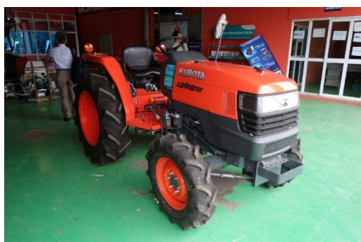
図 19 日本企業のアジア向け海外製品を扱う販売代理店 （右下：トラクタはフロアシフトで 4 段変速のシンプル仕様）
