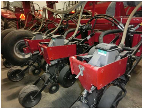
図 7 高速高精度播種ユニット
