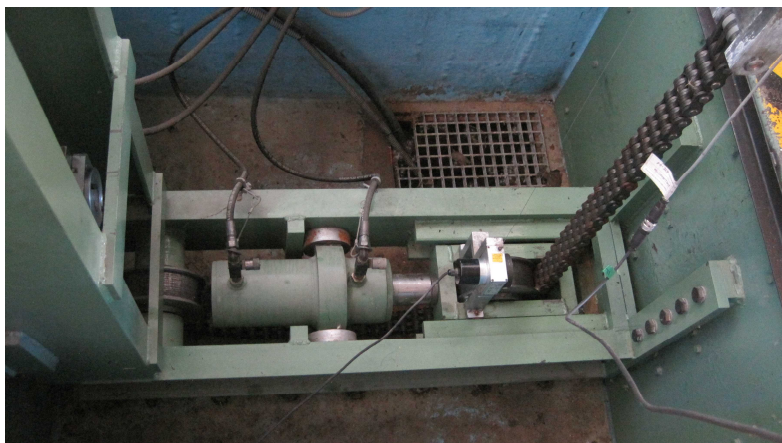
図 5 EMA の油圧揚力試験装置
