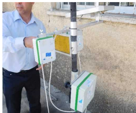
図 10 害虫モニタリングシステム
