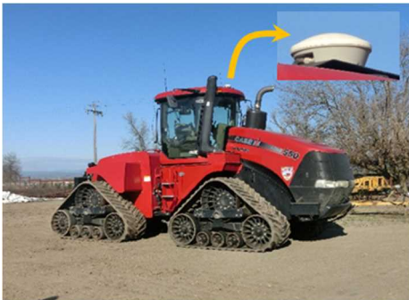
図 13 GPS 搭載の大型トラクタ
