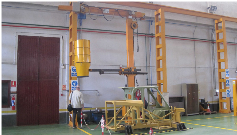
図 4 EMA の落下物防護構造（FOPS）強度試験装置
