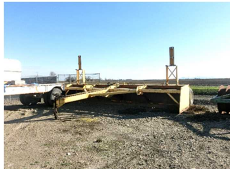
図 14 均平作業用のレベラー
