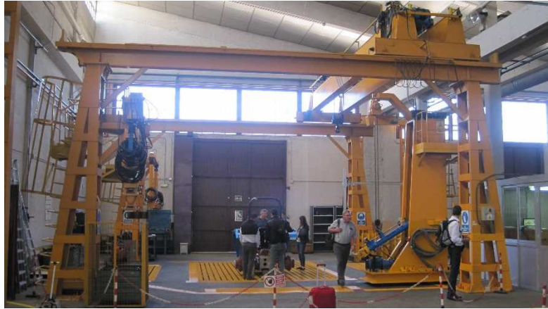
図 3 EMA の ROPS 強度試験装置
