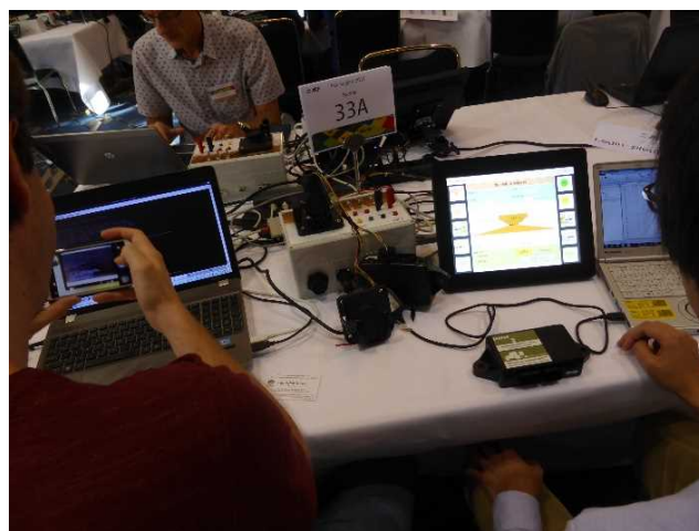
図 2 相互接続試験の様子 (右上のモニター : UT、右下 : 作業機 ECU (AgriBusBoard32))
