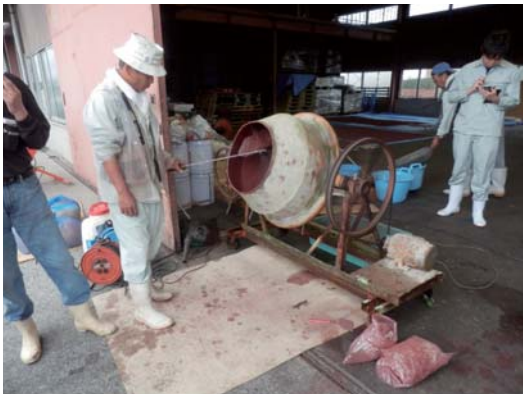
写真1 水稻「たちはるか」べんがらモリブデン被覆作業 コンクリートミキサーを利用して、水稻種子にべんがらモリブデンと糊の混合物を被覆している様子（2015年6月3日 上峰町で撮影）
