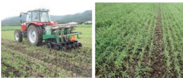
写真1 不耕起播種機によるスーダングラスの播種と発芽状況
