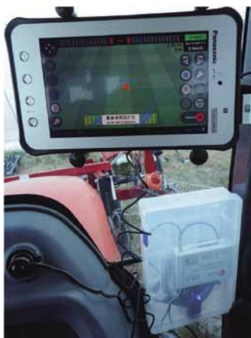
タブレットコンピュータとGNSS受信機を 組み合わせて構成されたガイダンス
