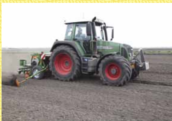
乾田直播の播種(速度12km/h)
