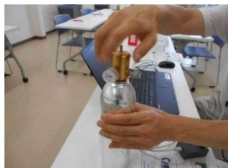
図 2-14 基盤にボンベをセットし校正
