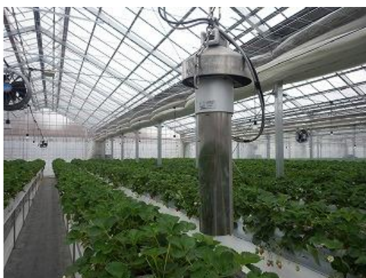
強制通風筒（縦型）による温湿度センサー
