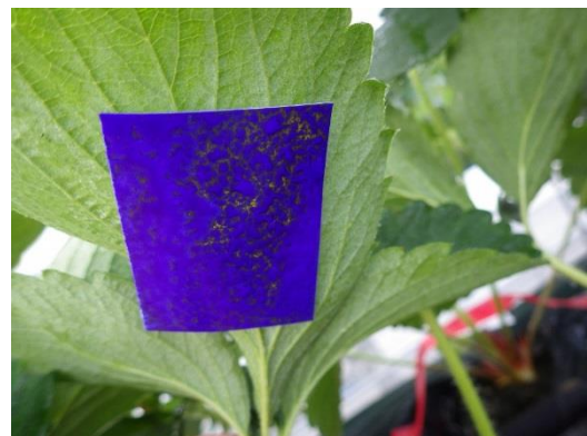
感水紙による薬液の付着確認 水に濡れた箇所が黄色から青色に変色する。
