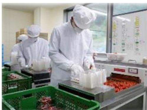
図10 非破壊糖度センサーつき選果ラインによる選果
