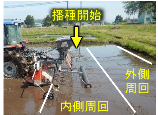
内側周回に半分重なる位置から播種を開始すると、ちょうどいい位置で種子が落下し始める
