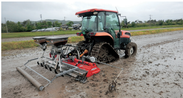
▲写真1 / 水稲無コーティング種子代かき同時浅層土中播種
