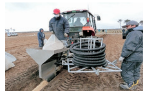
▶考案したアルミフレーム材を用いた軽量暗渠管リール
