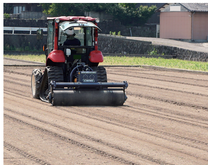
▲写真1 漏水対策の作業風景 （開発した 180cm 幅振動ローラを使用）
