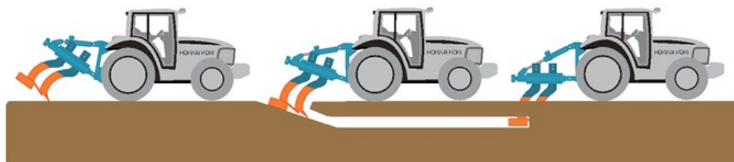
地表からの穿孔による補助暗渠の施工方法
