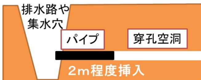
穿孔部へのパイプ挿入
