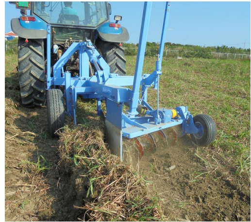
カットソイラーの施工状況
