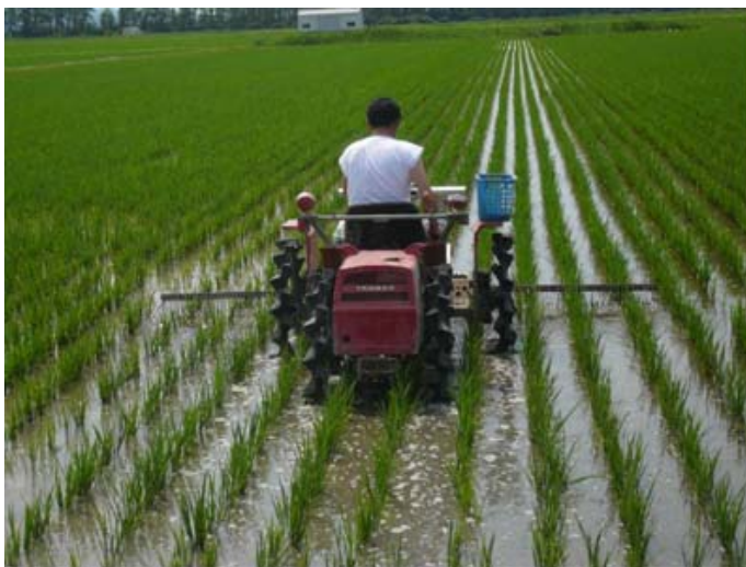
AF経営が中古田植機を加工して自作した乗用チェーン除草機
