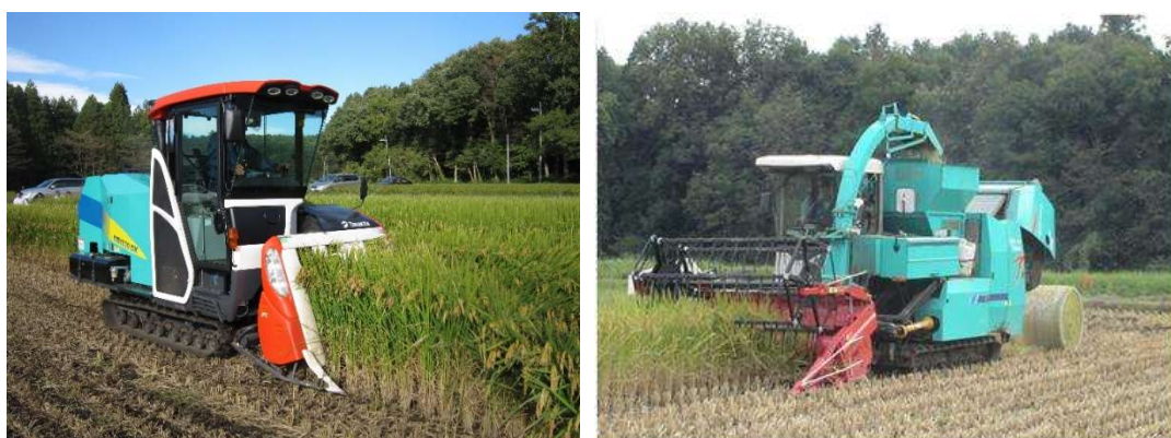
図 1-6 WCS 用イネの収穫用作業機 (左：コンバイン型専用収穫機、右：汎用型飼料収穫機)
