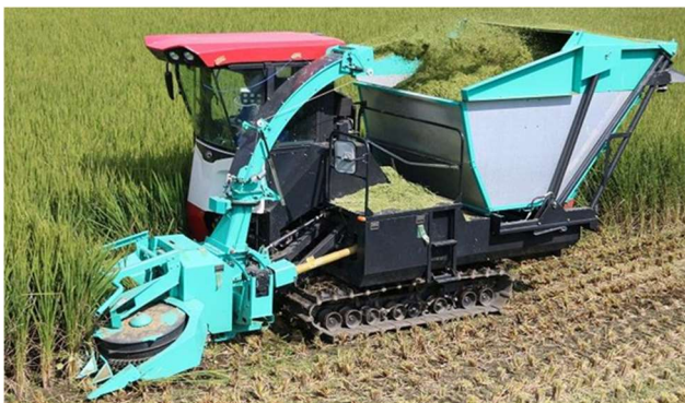
図 4-1 微細断収穫機 （左：ワゴンタイプ、右：ロールベータタイプ）
