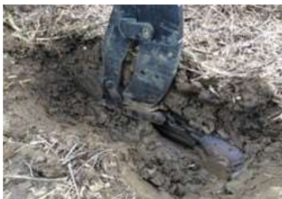
中型トラクタで 40cm 以深への 1 連穿孔の設定で浅くしか入らない心土破碎の刃と弾丸の例
