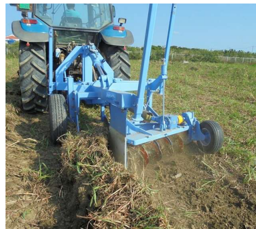
カットソイラーの施工状況
