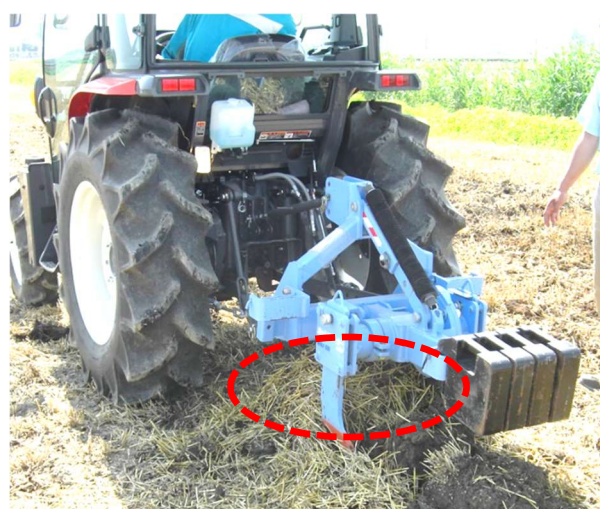
図V-5 麦わらや土が施工機に詰まった状況
