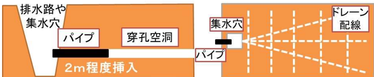
穿孔部へのパイプ挿入
