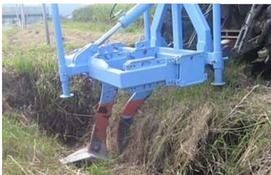
排水路からの穿孔
