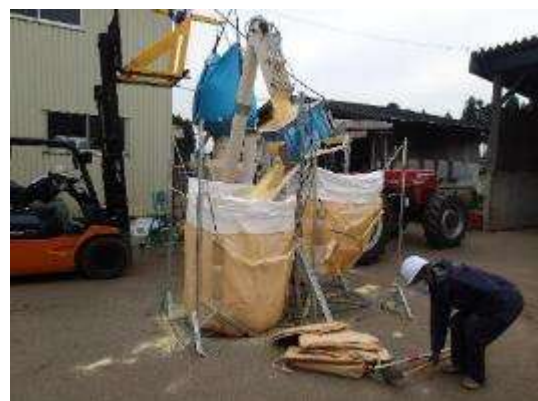
図Ⅲ-8 フレコン振り分け器(自作)
