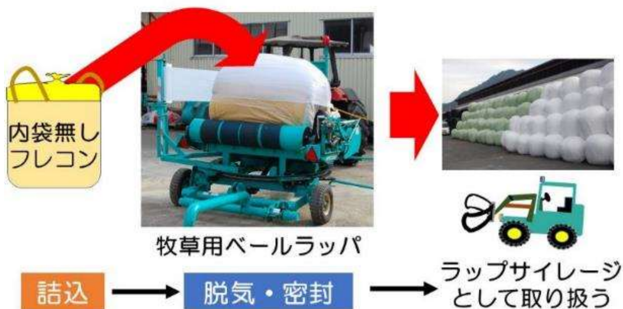
図 I -3 フレコンラップ法の概要
