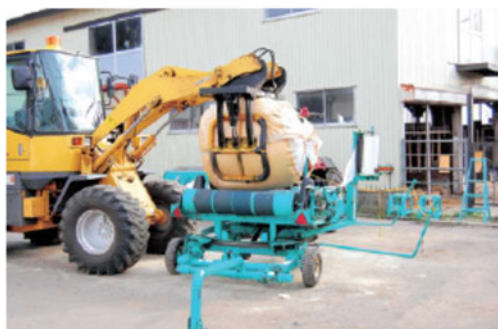
図 Ⅲ-6 フレコンラップ法による籾米サイレージ調製作業の流れ (続き)
