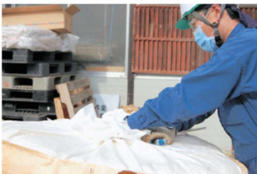
フレコン投入口の結束作業：1名
