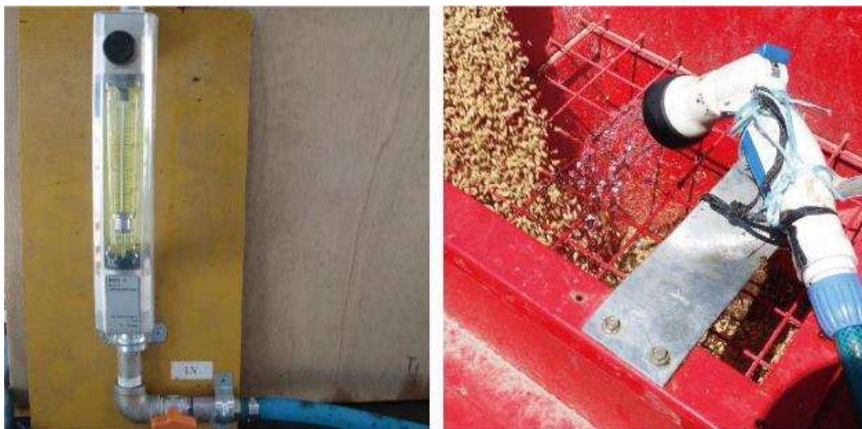
図Ⅱ-1-① ニードル弁付流量計を用いた加水量の調節方法
