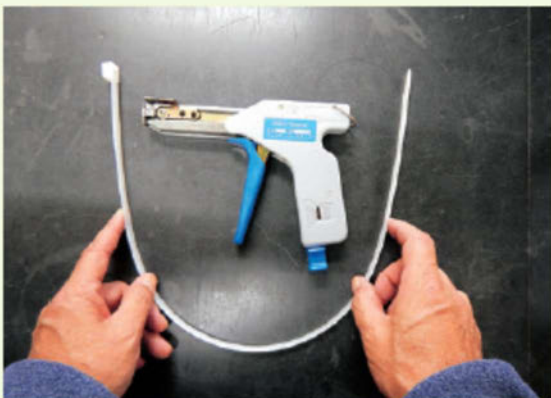
手動結束機でビニール帯を締める 例：PANDUIT 社製ケーブル帯用 手動式結束工具 (GS4EH) (結束機の結束強度は 30kg 程度のもの)
