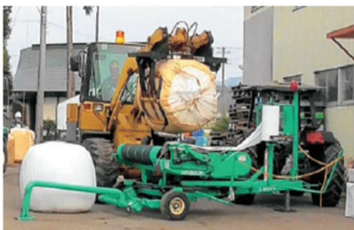
図 Ⅲ-6 フレコンラップ法による籾米サイレージ調製作業の流れ (続き)
