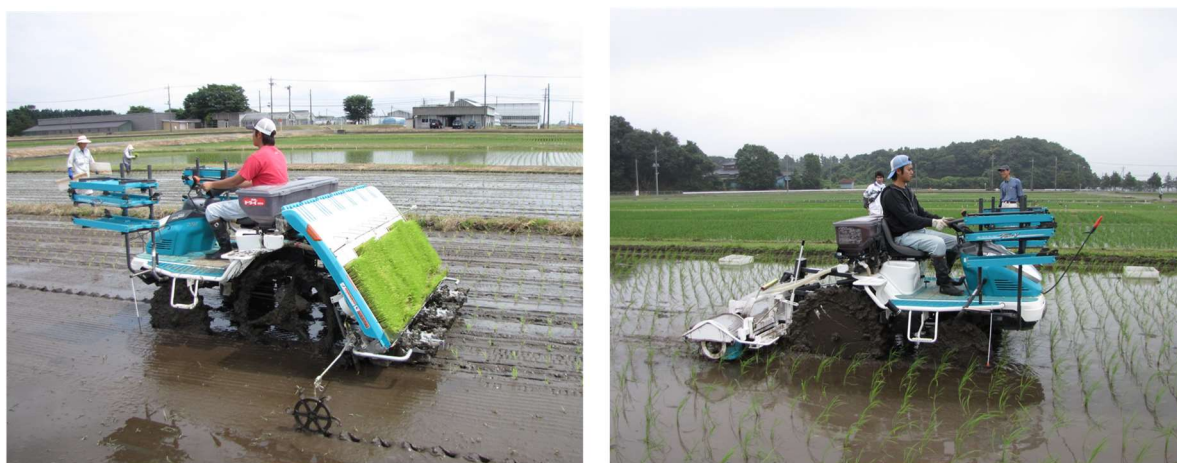
図 7 - 1 1 多目的田植機による移植作業（左）と高精度水田用除草機による除草作業（右）
