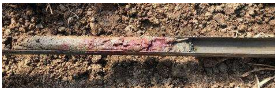
図 5 還元化土壌のジピリジル反応
