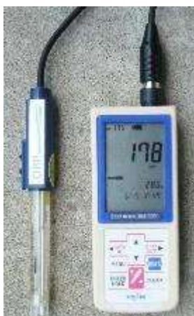
図 2 携帯型酸化還元電位計 (東亜 DKK)
