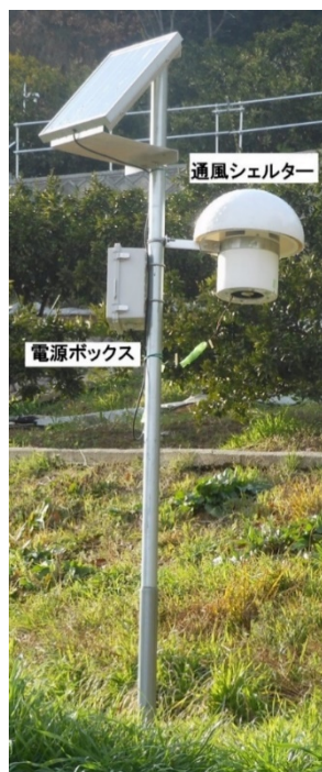
図IV-17 気温データ自動収集装置の外観
