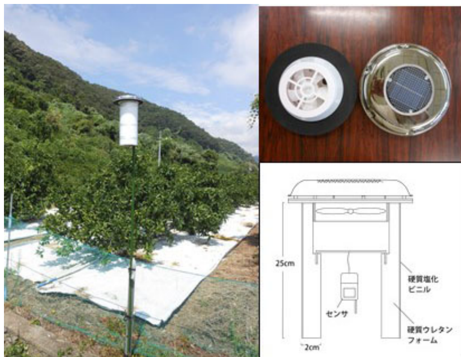
図IV-1 自作の気温観測装置
