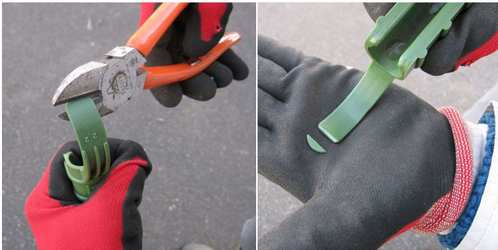
図Ⅲ-8 フィilmトメールの腕の先端を5 mm 程度、切り落とす
