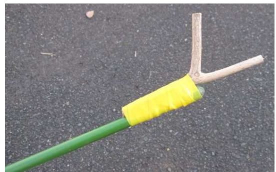
図Ⅱ-2 Y 字竿は、軽くてしなりにくい棒に二又の枝などを取り付けて作る
