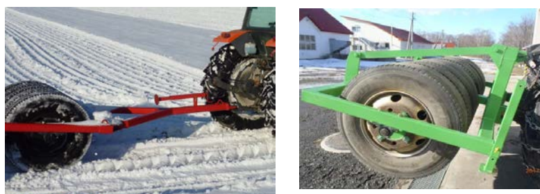
図Ⅲ-4 けん引式（左）および直装式（右）のタイヤローラを用いた雪踏み実施状況
