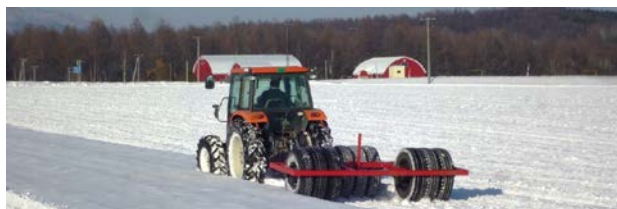
図Ⅲ-3 タイヤローラを用いた雪踏み実施状況
