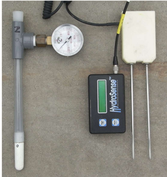
図 I -4 代表的な土壌水分計 左はテンシオメーター、右は TDR 土壌水分計
