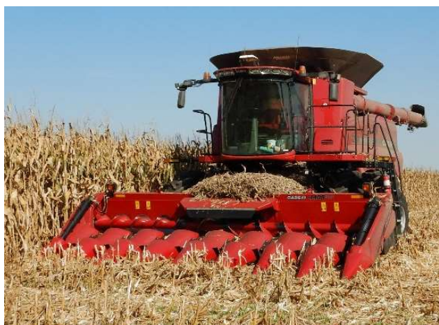
図Ⅱ-15 アメリカにおけるスナツパヘッドを装着した汎用コンバイン
