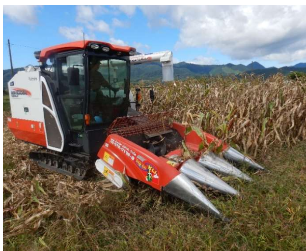
図Ⅱ-17 小型スナツパヘッドを装着した国産汎用コンバイン
