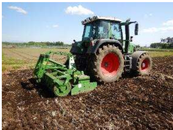
図Ⅱ-5 トラクタに装着したパワーハローの全体（左）とタイン（右）
