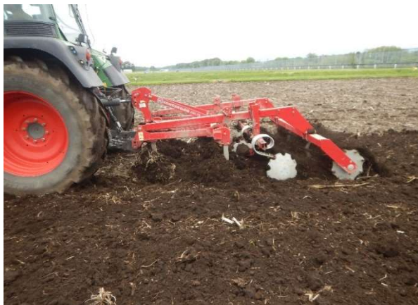
図Ⅱ-4 トラクタに装着したチゼルプラウの全体（左）と爪（右）
