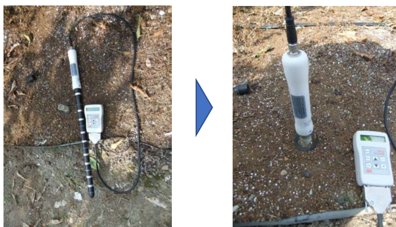
図IV-1 プロファイル土壌水分計（左）とその測定の様子（右）
