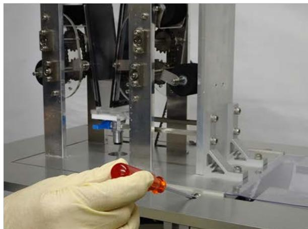
(B) 透明平板のネジ外し (2か所)
