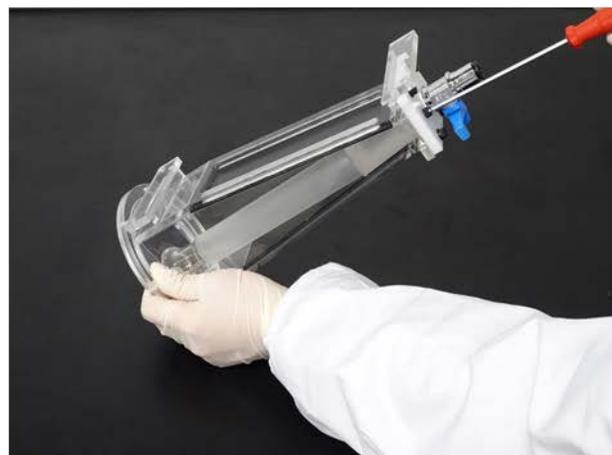
図 II - 7 消化試験容器内部への底板の固定
