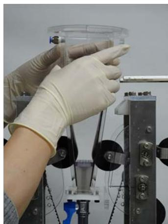
図 III- 6 消化試験容器の取り外し
