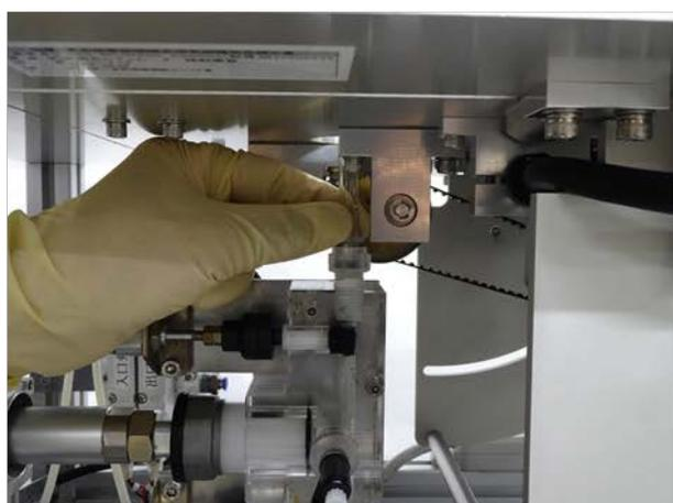
図 III- 4 消化試験容器と排出用チューブの接続
