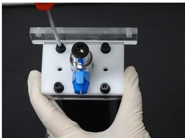
図 II - 6 消化試験容器へのバルブ付き平板の固定
