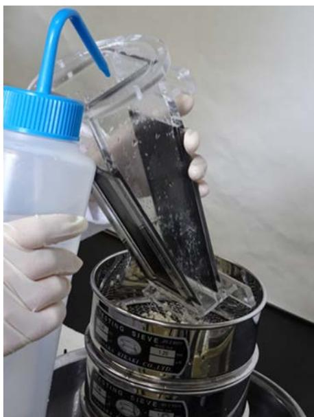
**図 II - 17 消化試験容器に残存した胃消化物の洗い込み**
