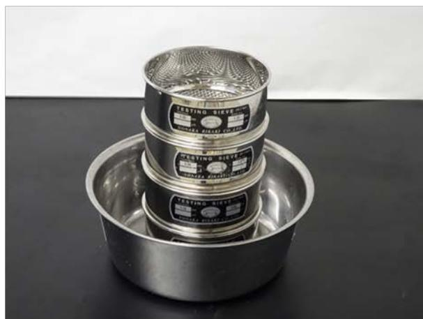
図 II - 15 多段積層篩のたらい中への設置
