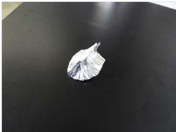
図 II - 20 透過画分の採取およびアルミカップへの封入
