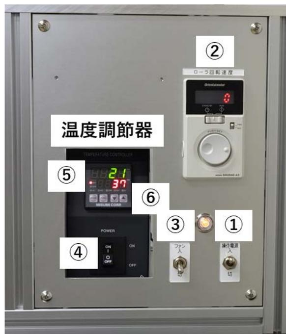
図 II - 4 制御盤および温度制御器
