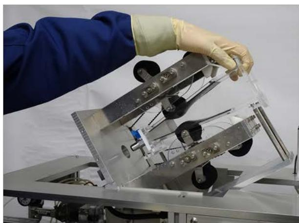
**図 II - 11 消化試験容器の傾斜操作方法**
