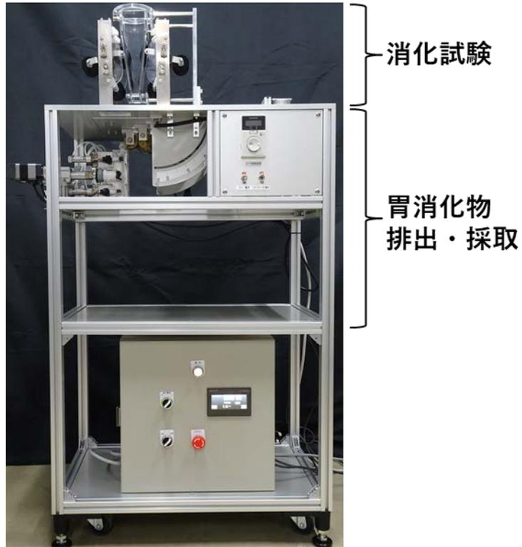
図 III - 2 床置き・可動タイプの連続型胃消化シミュレーター
