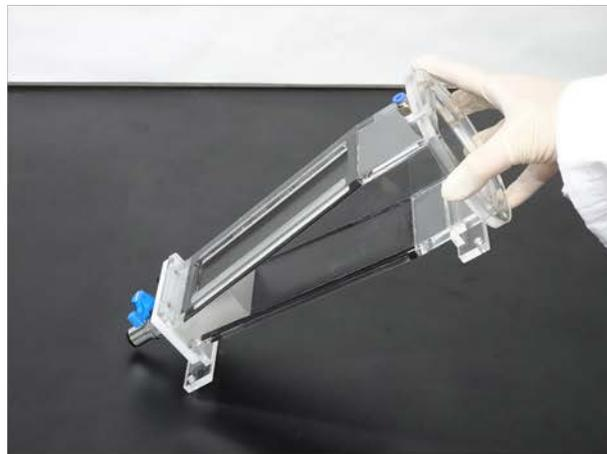
(C) ネジ留めによる底板の固定
