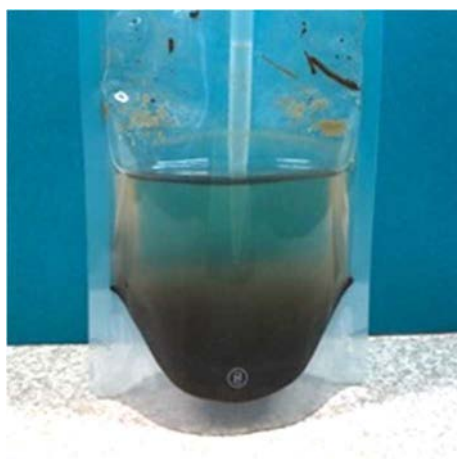
図 II -18 チャック付きラミネート袋（ラミジップ）から土壌の増菌培養液のサンプルング
