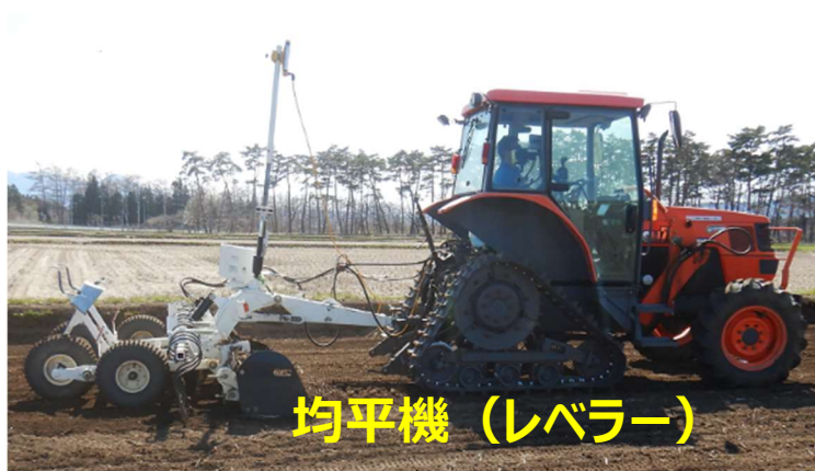
図IV-5 均平作業の様子
