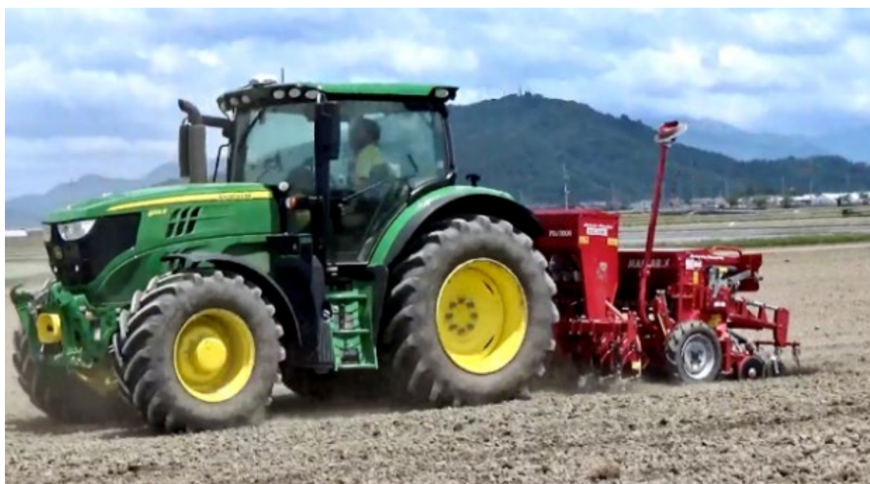
図V-1 グレーンドリルによる播種作業
