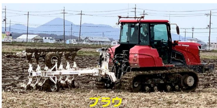
図IV-1 プラウによる反転と耕起後の圃場
