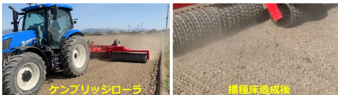
図IV-4 ケンブリッジローラによる播種前の鎮圧
