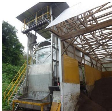
図 I -1 密閉縦型堆肥化装置
