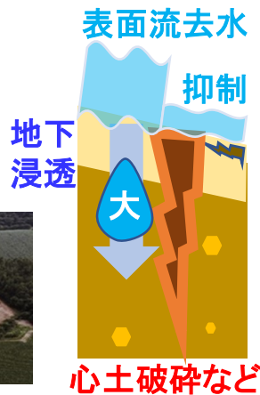
「カットソイラー」の実施
