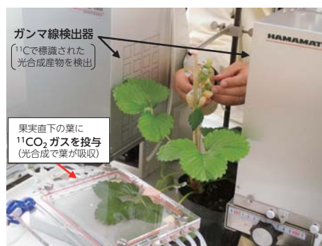
▲図2 ポジトロンイメージング装置（PETIS）によるイチゴ果実への光合成産物の転流の計測
