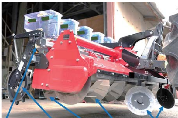
種子繰出部 直播作業部 畝成形補助部 覆土・鎮圧部 畝成形部
